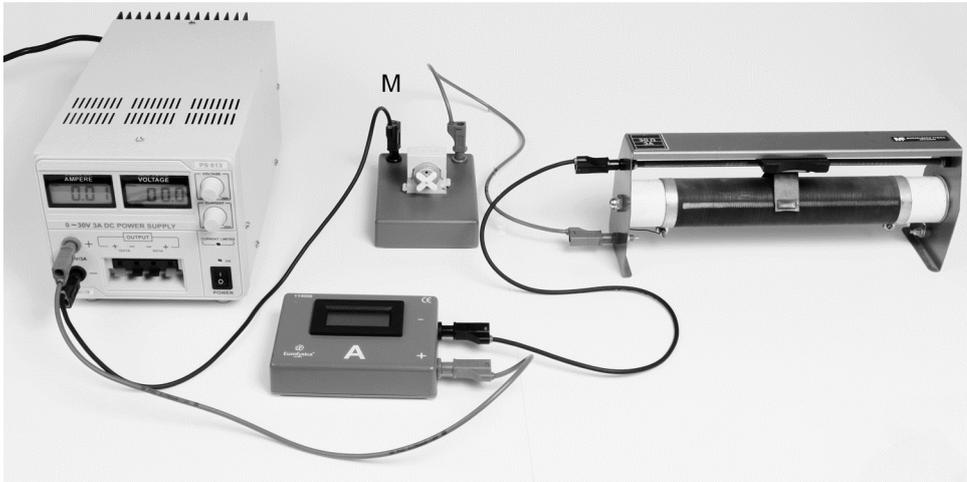
Tijdens hun onderzoek levert de spanningsbron steeds dezelfde spanning. Als de stroomkring gesloten is, loopt er een stroom van 0,2 A door de elektromotor.
